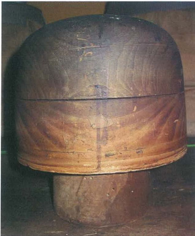
La coppa utilizzata per informare la cupola del cappello alpino mod. 1910: una vera e propria scultura in legno. La stessa forma serve per la cupola delle bombette ottocentesche.
